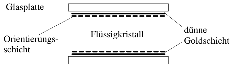
Abbildung 5: Aufbau des LC-Fabry-Perot-Filters
